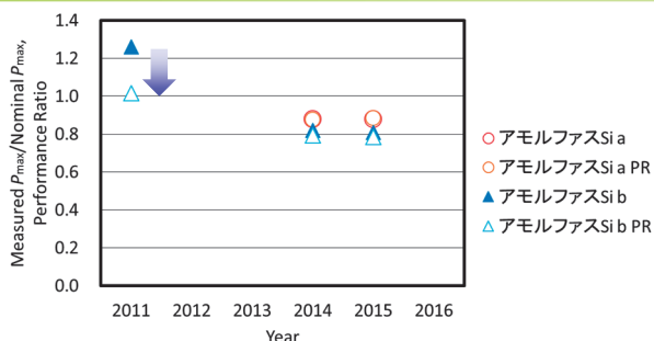
図1. アモルファスSiの屋内測定とPRの比較
