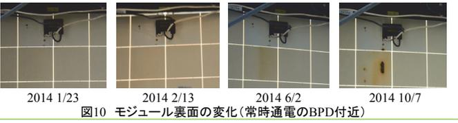
図10 モジュール裏面の変化(常時通電のBPD付近)
