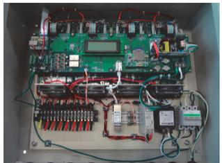
図4 故障監視装置試作品
