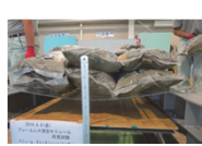
砂袋を用いた耐荷重試験の様子
