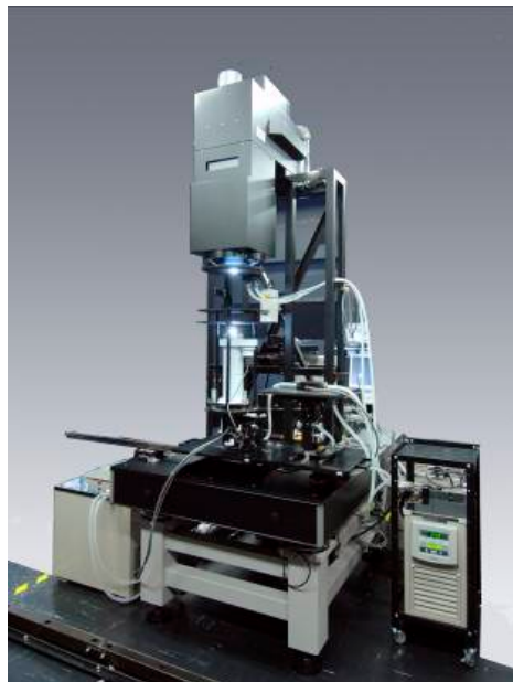
高平行度ソーラシミュレータ 特許: 4982884(日本), 8016439(米国)
