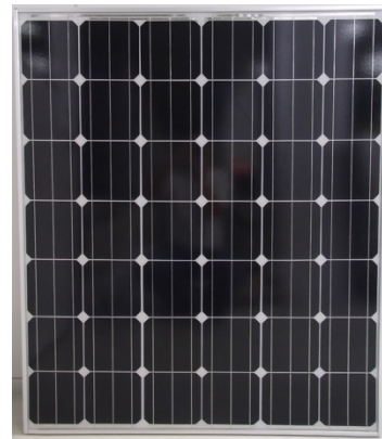
図 II-24-3-5. CF 接続で作製したバスバーレスセルの市販サイズモジュール
