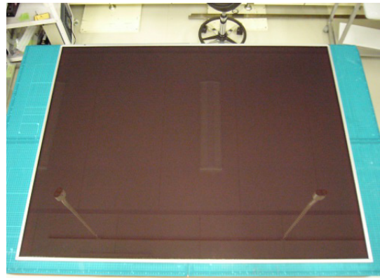
図 3.3.4. 試作した薄膜系（アモルファス）フルサイズモジュールの外観写真
