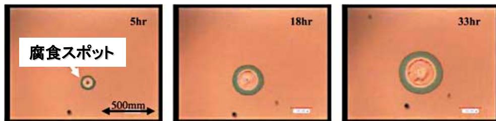
水分との反応による腐食スポットの拡大
