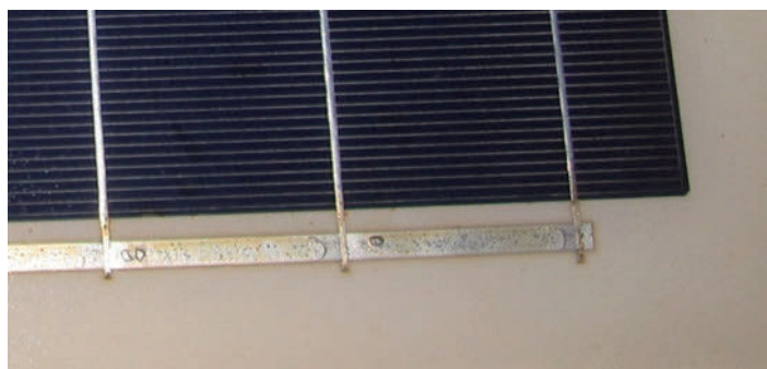
図 6.3.3 DH3000 時間後のタブ線の外観
