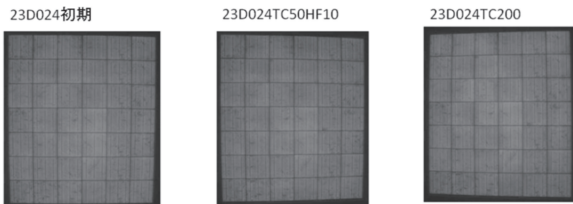
図 6.4.8 23D024PAAC モジュールの EL 画像の TC/HF 試験サイクル数依存性
