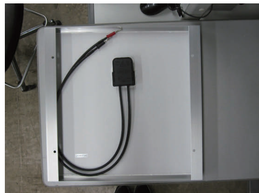
図 6.1.4 バナナ端子のチェックモジュール
