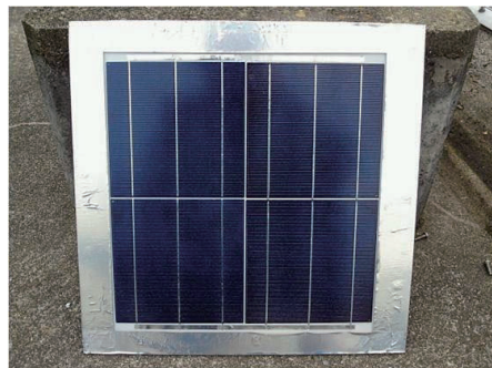
Fig.4 屋外曝露に使用したモジュール
