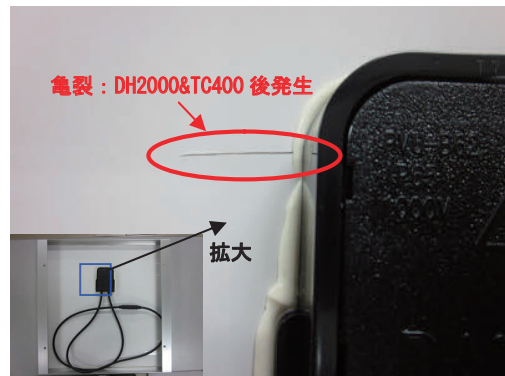
図1. DH&TC 組み合わせ試験による外観不具合
