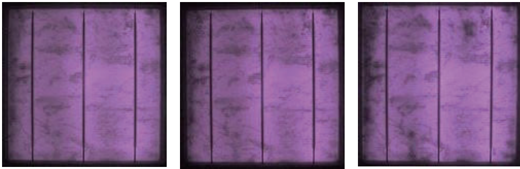
図 6 : EL 画像 (F-coat 系 左から、DH1000,3000,4000 hr.)
