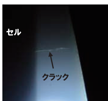
図 III-2-3. BS1 使用モジュールのクラック (モジュール端部の透過光観察)
