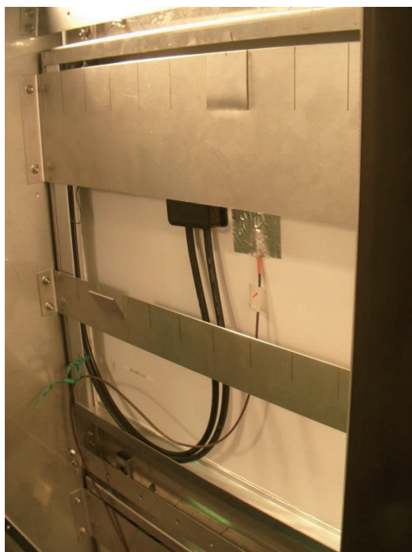
図 II-3-2-2. 端子ボックスと熱電対の位置
