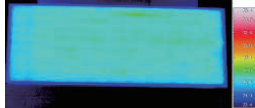
図 II-3-3-12. 劣化が小さい c2-08b モジュールの I-V 曲線、EL 画像、順方向熱画像
