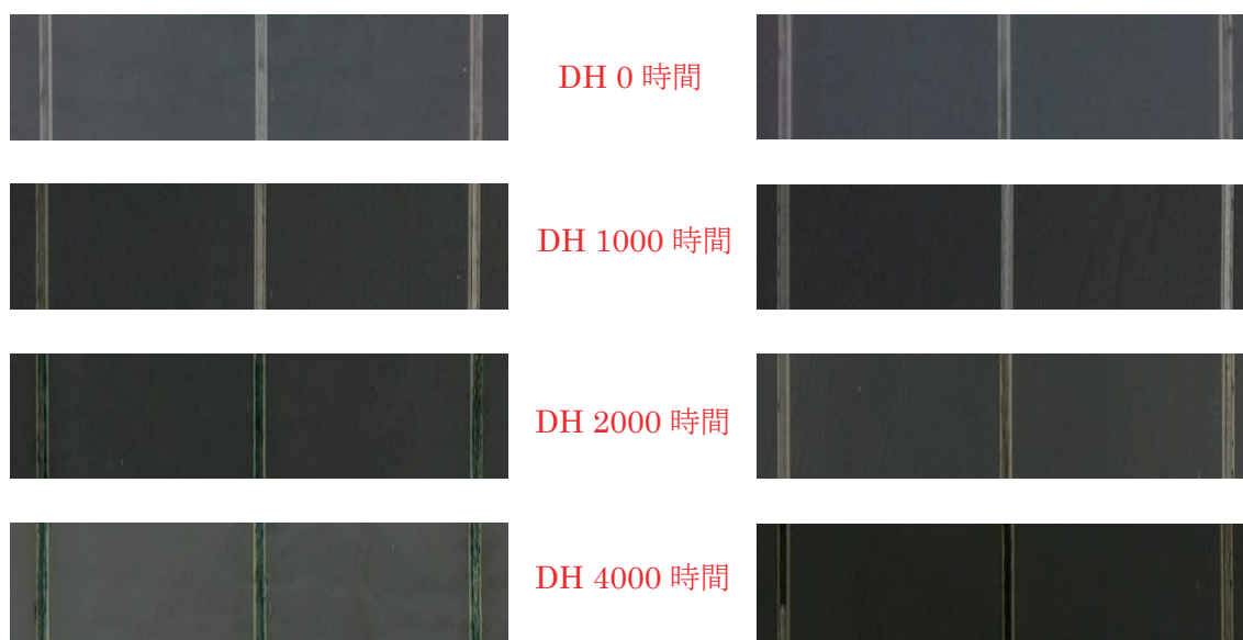
図 II-3-4. 85 °C、85%RH 条件下の環境試験後のモジュールの裏面 (左 : EFEP、右 : FEP)
