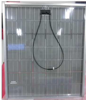
図 II-14-2-2. 透明バックシートを使用したモジュール裏面外観
