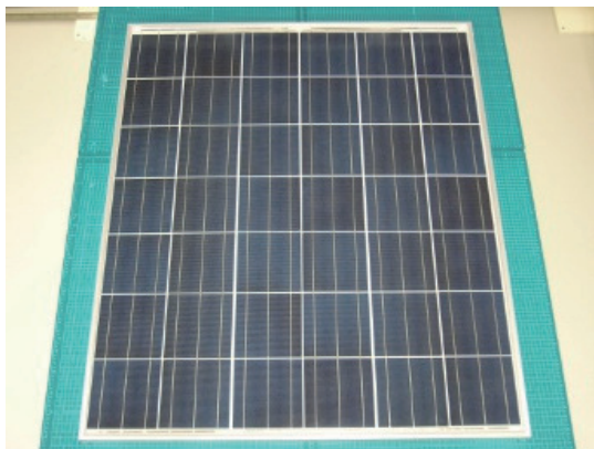
図 3.9 試作した結晶系フルサイズモジュールの外観写真
