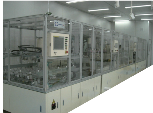
図 3.2 薄膜基板自動配線装置の外観写真
