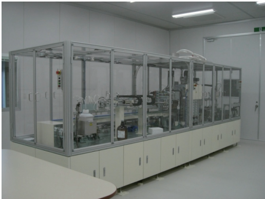
図 3.1 セル自動配線装置の外観写真
