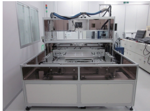
図 3.4 ブチル塗布・フレーム取付装置の外観写真
