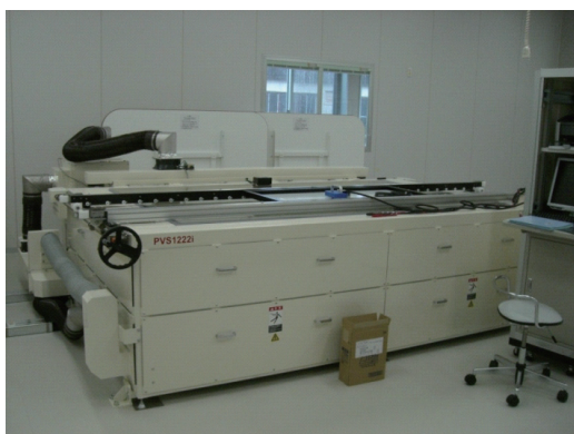
図 3.5 ソーラーシミュレータの外観写真
