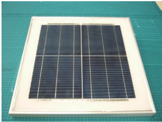
図 3.7 試作した結晶系 4セルサイズモジュールの外観写真
