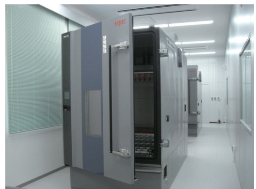
図 3.6 環境試験装置の外観写真
