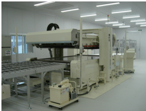
図 3.3 真空ラミネータの外観写真
