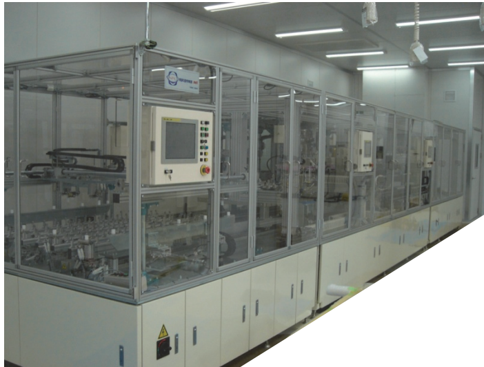
薄膜系太陽電池モジュール自動配線装置 (エヌ・ピー・シー製)
