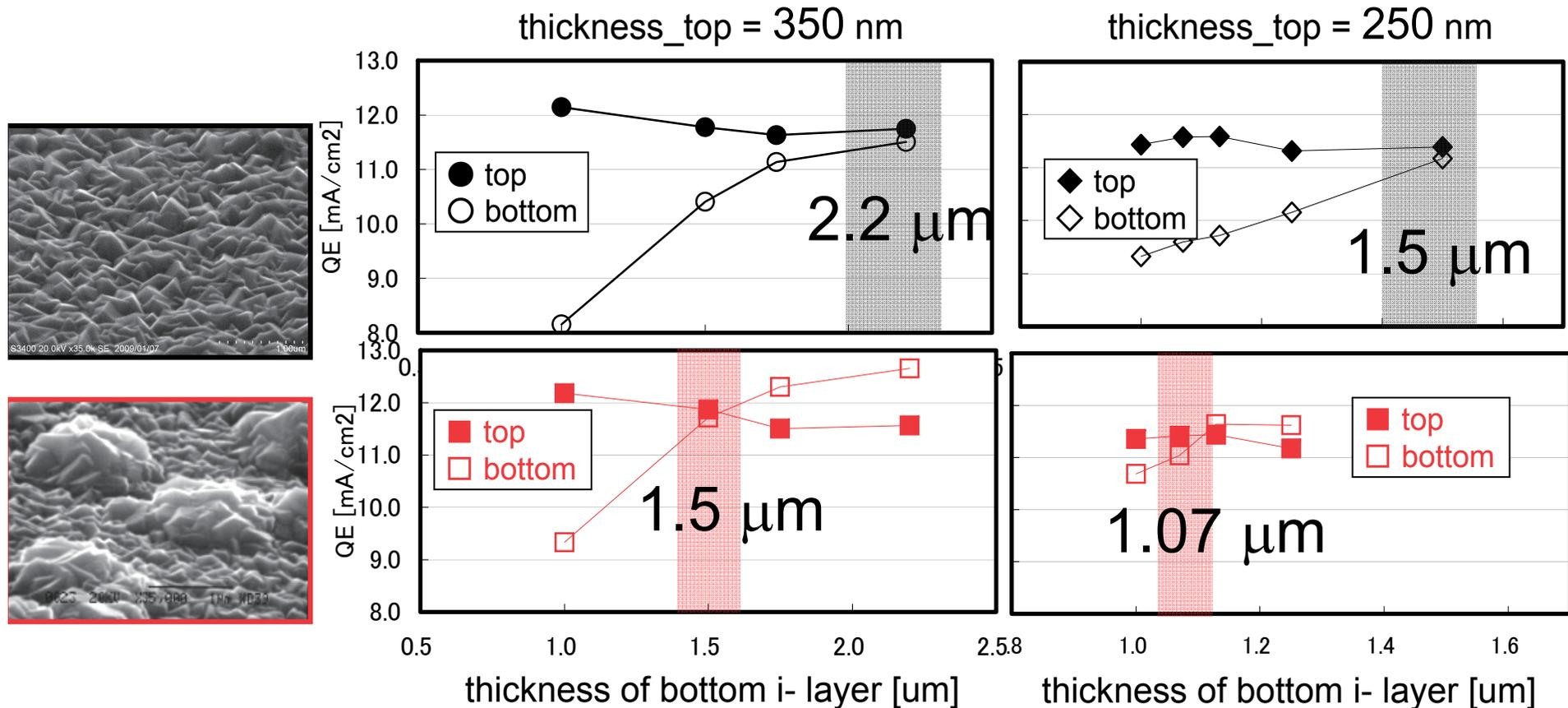
高ヘイズW-tex. TCOによりボトム微結晶Siの膜厚を約30%削減可能
