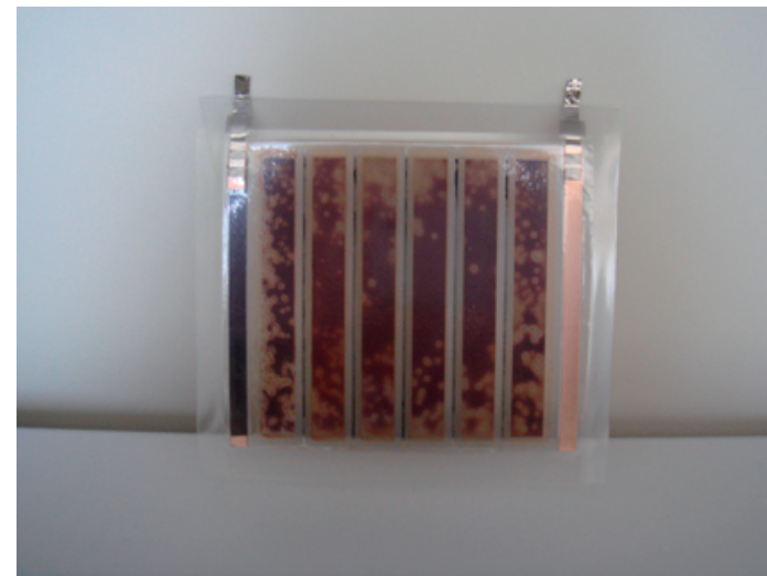
MK-2と低温焼成型酸化チタンを用いた プラスチック基板色素増感太陽電池
