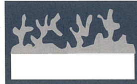
樹枝状(デンドライト)に析出した リチウム金属の模式図
