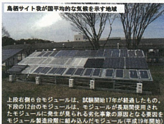
鳥栖サイト我が国平均的な気候を示す地域 上段右側6台モジュールは、試験開始17年が経過したもの。下段の12台のモジュールは、モジュールが長期使用されたモジュールに発生が疑われる劣化現象の要因となる要因をモジュール製造段階に組み込んだモジュール(平成19年開始)
