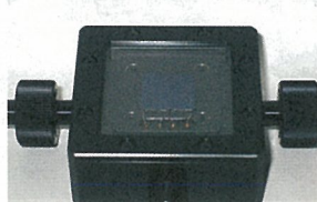
一次基準セル。太陽電池性能評価の原器となるもの。
