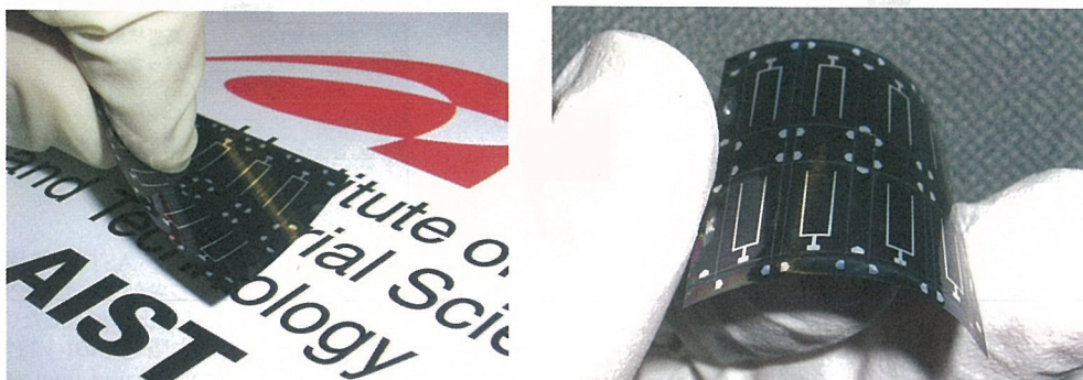
図：セラミックス(左)、およびチタン箔(右)を基板としたフレキシブルCIGS太陽電池。(flexible CIGS solar cells using ceramics and Ti-foil substrates.)
