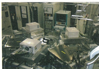
30x40cm 2 基板サイズの薄膜シリコン製膜装置。
