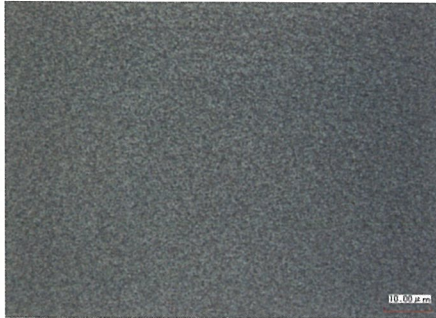
写真1(photo-1): 単結晶シリコン ランダムテクスチャー形成 single c-Si: random texture
