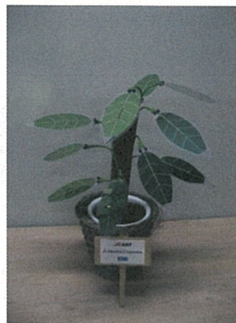
観葉植物型有機薄膜太陽電池モジュール（三菱商事、トッキとの共同開発、環境展に出展）
