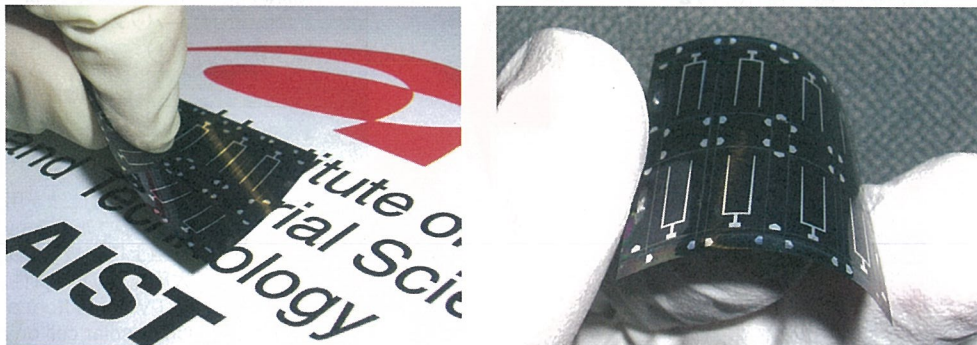
図：セラミックス(左)、およびチタン箔(右)を基板としたフレキシブルCIGS太陽電池。 (Photos of flexible CIGS solar cells using ceramics and Ti-foil substrates.)
