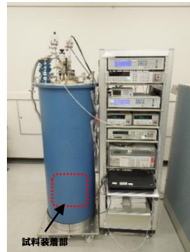
クライオスタット全景と試料装着部模式図
