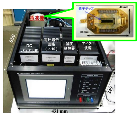
開発した19インチラック収納可能な小型量子電圧源
