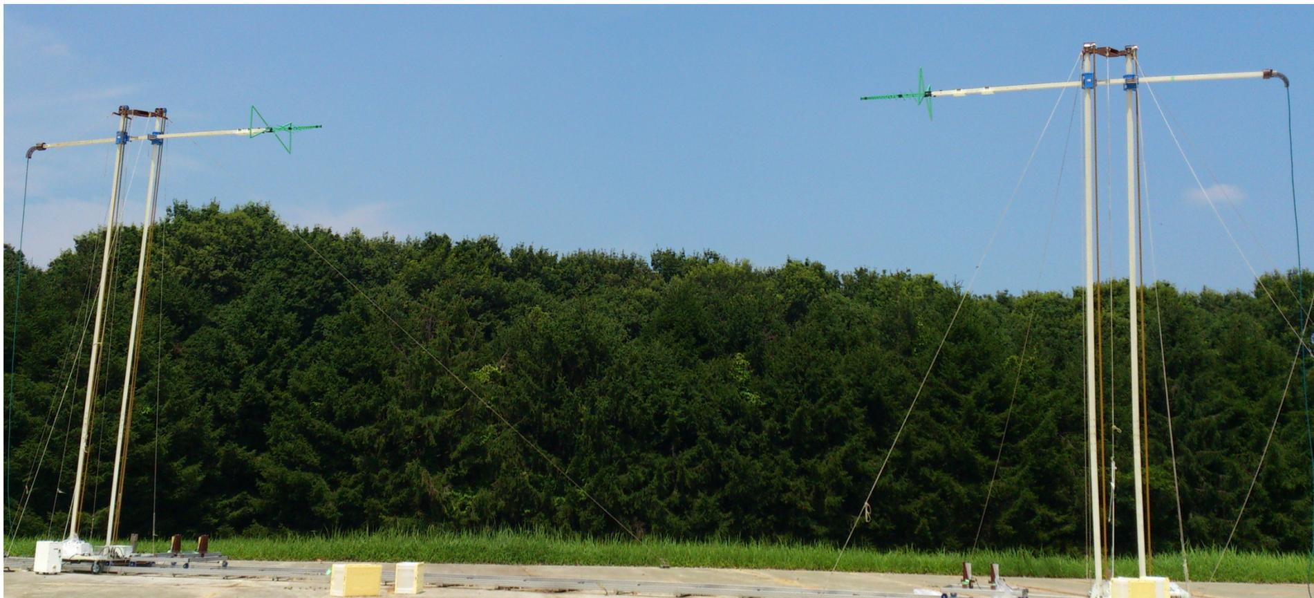
アンテナ間距離 3 m の周波数領域サイトインサージョンロス  $S_{21\_3m}(\omega)$  測定
