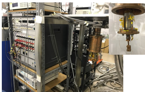
図1 冷凍機式熱伝導率測定装置（室温以下）
