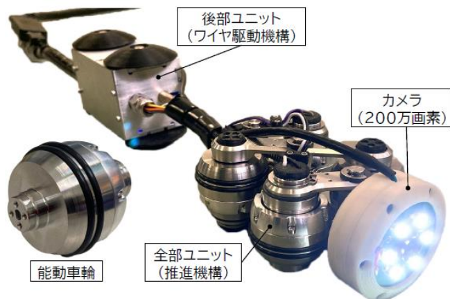
図2 下水道圧送管向け車輪駆動型点検ロボット
