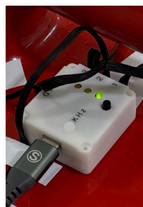
図2: 土木構造物における同時多チャンネル加速度解析のためのデータ収集システム
