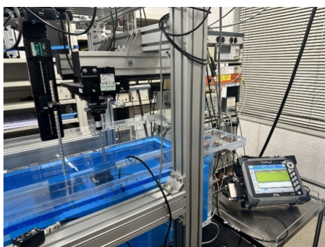
超音波探傷イメージング用アレイプローブから照射される超音波音圧の空間分布、瞬時波形の測定
