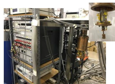
図4 整備中の熱伝導率測定装置
