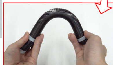
図1 (左) ロボット点検システムの全体図 (右) 柔軟な推進力発生機構
