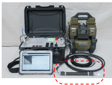
図1 (左) ロボット点検システムの全体図 (右) 柔軟な推進力発生機構
