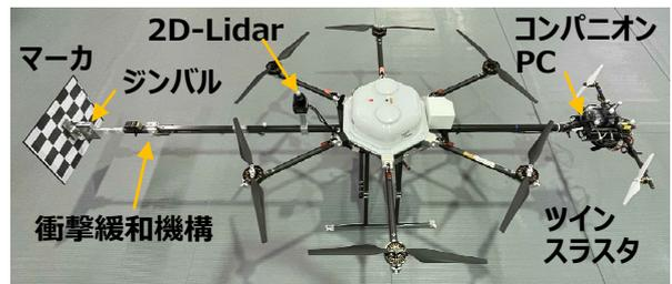
図2 市販ドローン（Eams Robotics社製）に装着したマーカ/センサボード貼付ユニット
