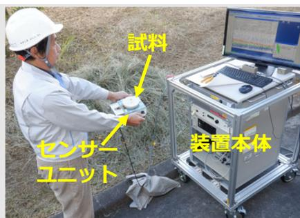
含水空洞のあるモルタルのテスト試料を計測中
