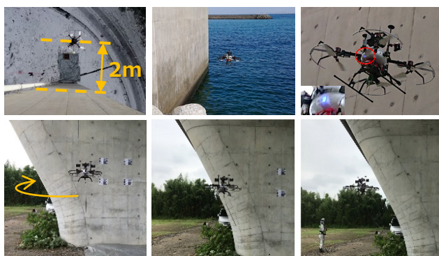
上段：一定離隔制御，安定ホバリング，LED通知 下段：曲面に対する機体の正対制御（回り込み）
