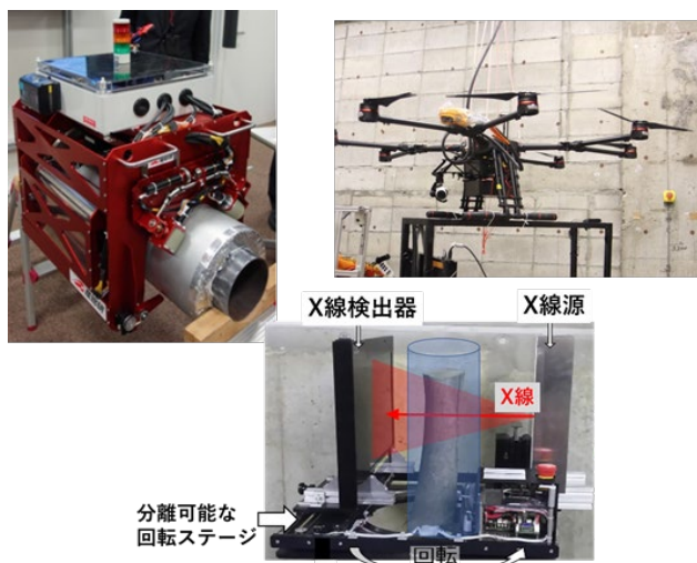
ロボットを利用したX線非破壊検査システム
