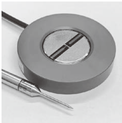
図1. 診断用超音波向け hidroホンの一例(メンブレン型(右)及びニードル型(左))
