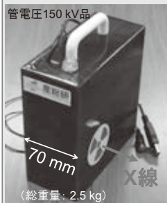
図1. 非破壊検査用X線源
