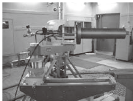
図3. 反跳陽子比例計数管
