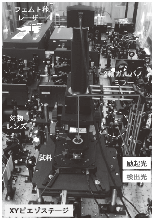
図5. 顕微過渡吸収イメージング分光装置の概観と主な測定結果
