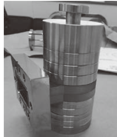
図 3. 非破壊検査用電子加速器型 X 線源に用いている C バンド加速管
