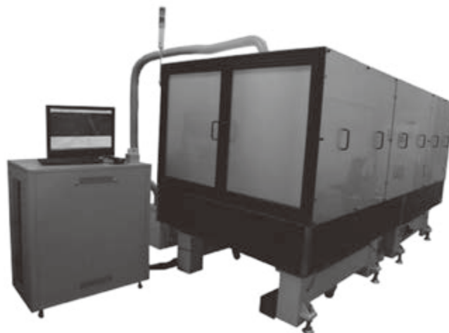
図 1. 超短パルスレーザー加工装置の外観
