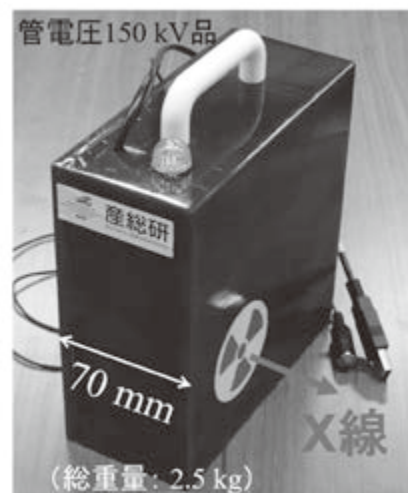
図2. 非破壊検査用可搬型X線源
