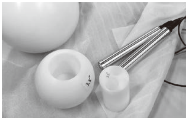
図 5. {}^6\text{Li}/{}^7\text{Li} ガラスシンチレーターと PMT を収めたハウジングと、ボナー球への挿入アタッチメント
