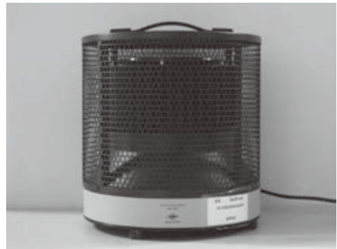
図1：基準音源の例（Type 4204：Brüel & Kjær）。音響パワーレベル測定において基準として用いられる。
