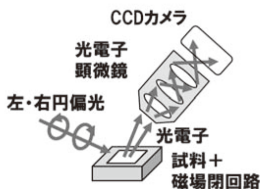
図 1. MCD と PEEM による磁区観察手法の概要図。
