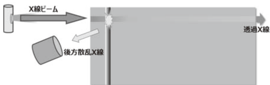
図 1. 後方散乱 X 線イメージングの概念図。
