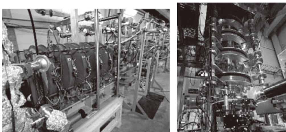
図3. 産総研電子加速器(左)と陽電子ビームライン(右)。
