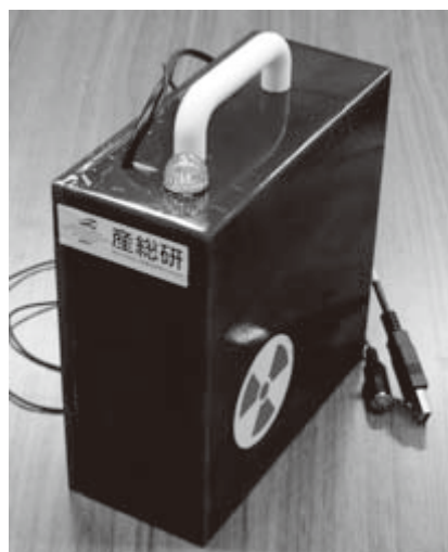
図2. 小型軽量な可搬型X線源。
