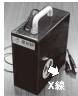
写真3. 開発したパルスX線源
