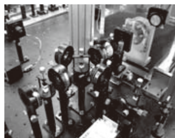
図 4. 周波数帯域 0.5 MHz～40 MHz 用レーザ干渉法によるハイドロホン感度校正システム。
