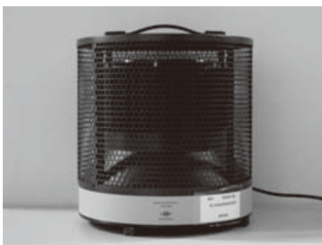
図 1. 基準音源(Brüel & Kjær type 4204)。
