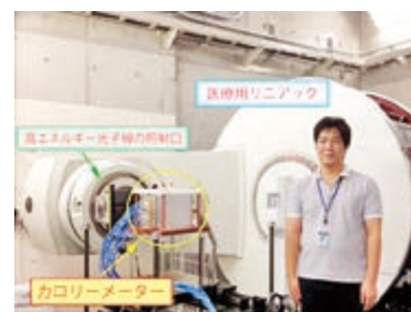
グラファイトカロリメータと 医療用リニアック装置 Graphite calorimeter and clinical linac
