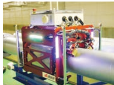
超小型 X 線源搭載ロボット Robot equipped with ultra-compact X-ray source
