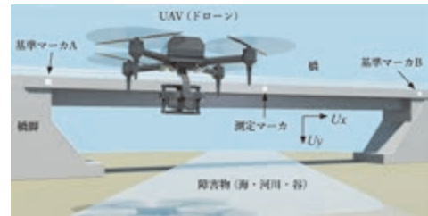
ドローン空撮による橋のたわみ計測 Measuring bridge deflection using aerial drone photography
