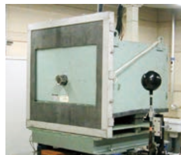
300 kV 以下の X 線の国家標準器である 平行平板自由空気電離箱 Parallel-plate free-air ionization chamber, the primary standard for x-ray below 300 kV.
