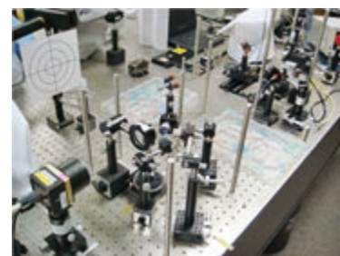
スペクトル強度干渉断層イメージング装置 Intensity-interferometric spectral domain optical coherent tomography (I-SD-OCT)
