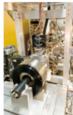
集束陽電子ビーム欠陥評価装置
