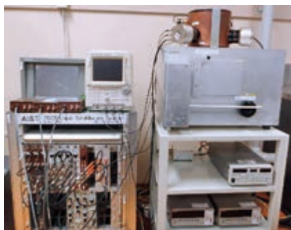
放射性医薬品に適用する放射能絶対測定装置
