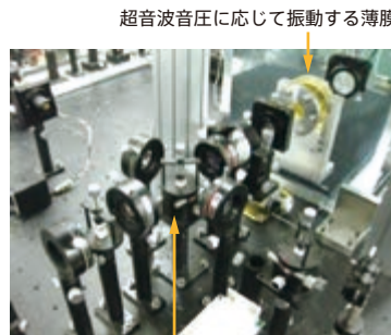
薄膜の振動を計測する干渉計
