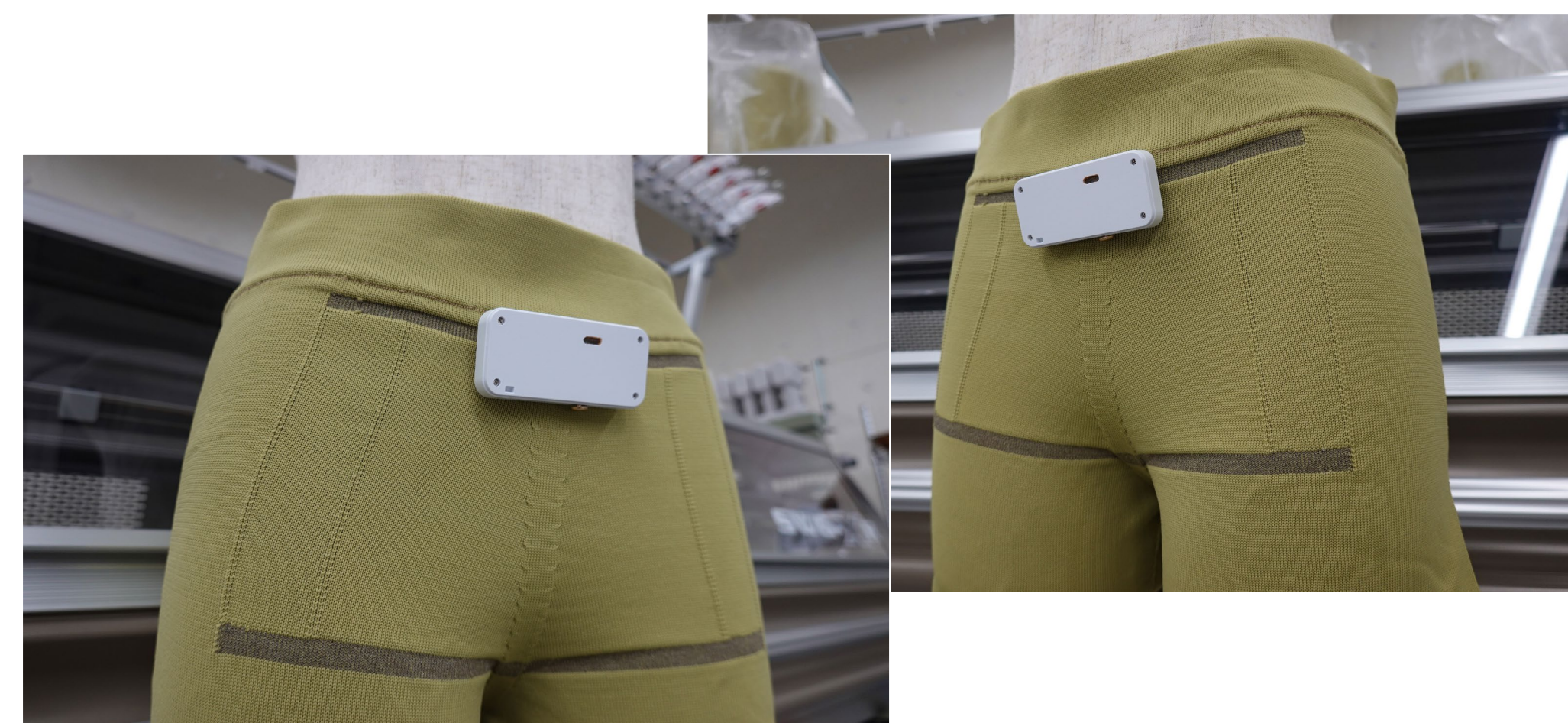
無縫製横編機で作製した呼吸をセンシング可能な ニット型センシングウェア
