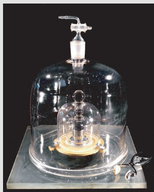
写真 1 国際キログラム原器：直径、高さともに 39 mm の白金イリジウム製円筒形分銅 (Photograph courtesy of the BIPM)
