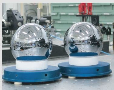
写真2 ^{28}\text{Si} 単結晶球体：1個あたりの製作費用は約1億円
