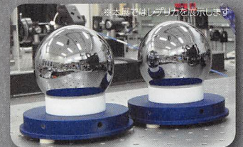
プランク定数の精密測定に使用されたシリコン単結晶球
