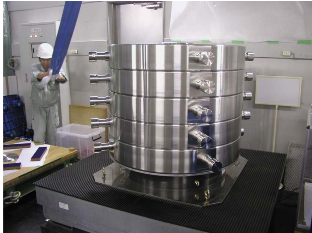
新開発の6000 kg質量比較器を用いた 5000 kg分銅の校正
