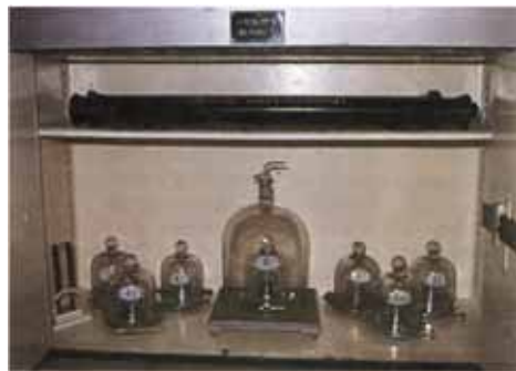
国際度量衡局(BIPM)で管理されている国際キログラム原器とその公式複製
