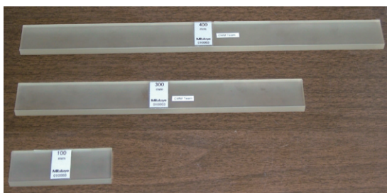
写真1 低熱膨張ガラス(クリアセラム)製ブロックゲージ
