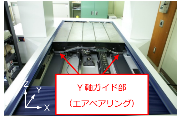
図 3 軸ガイド部の外観
