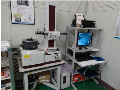
図2 実験に用いた真円度・円筒形状測定機の外観
