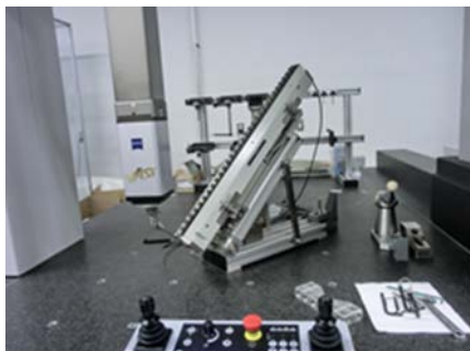
図 3 Space1 測定状況 (スタイラス Direct)
