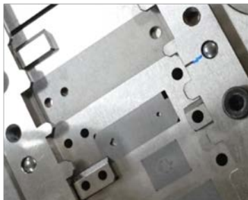
図1 小穴を含む金型部品の事例
