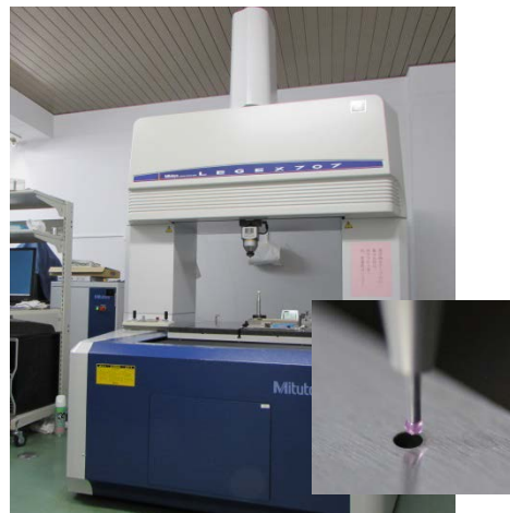
図3 CMMとプローブによる小穴測定
