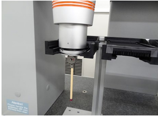
図4 ラックを使ったプローブ脱着の様子
