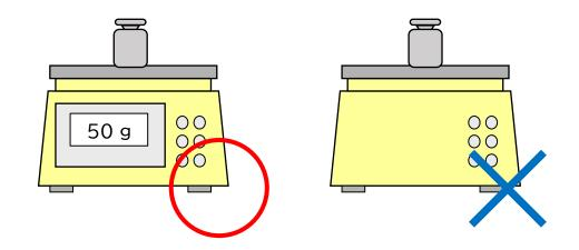
検出部と構造上一体となった表示機構を持つ (特定計量器検定検査規則第十一条)
