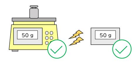
複数の表示機構はいずれも検定に合格していること (特定計量器検定検査規則第十三条)
