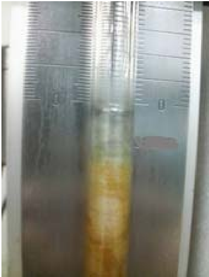
①ガラス管汚れ
