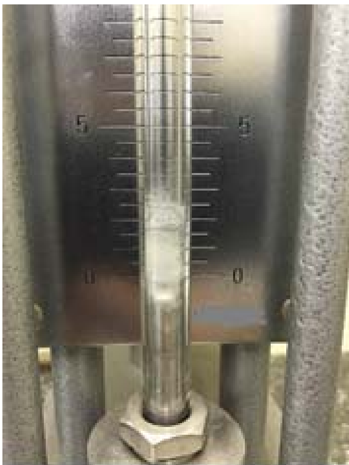
③ ガラス管汚れ
