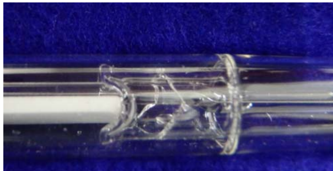
例) ガラス破損
