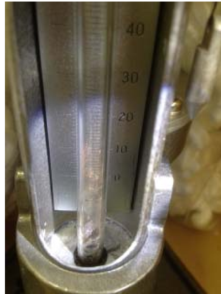
②ガラス管汚れ
