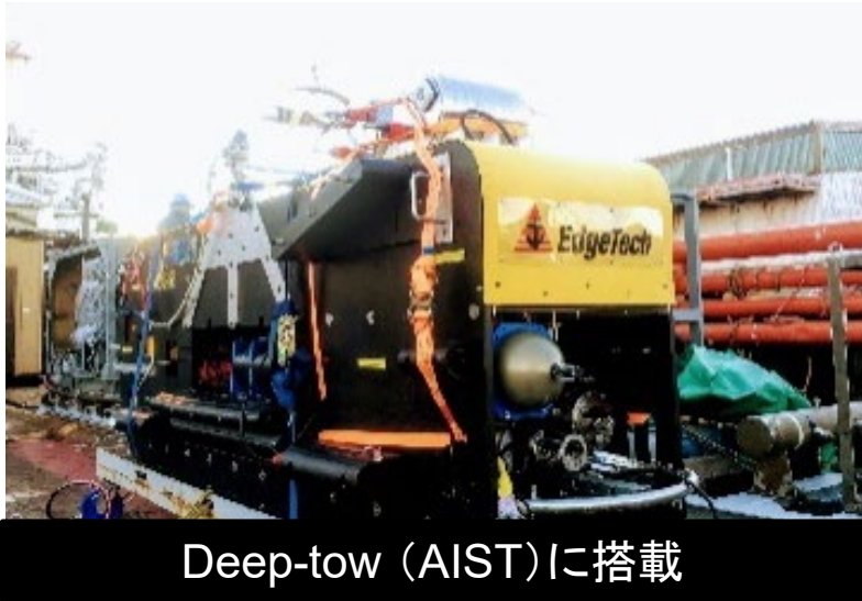
JAMSTECにおいて耐圧試験を実施し 20 Mpa (水深2,000 m)をクリア
