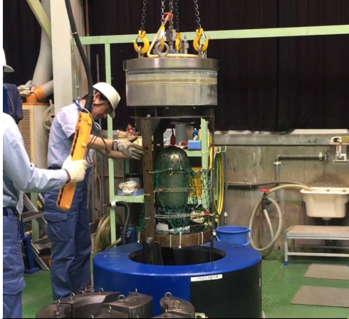
JAMSTECにおいて耐圧試験を実施し 20 Mpa (水深2,000 m)をクリア
